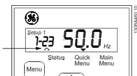
Disegno 3.6 Indicazione della direzione del motore
