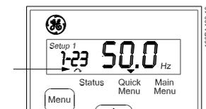
图 3.6 表示电动机方向
