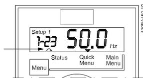
图 7.7 表示电动机方向
