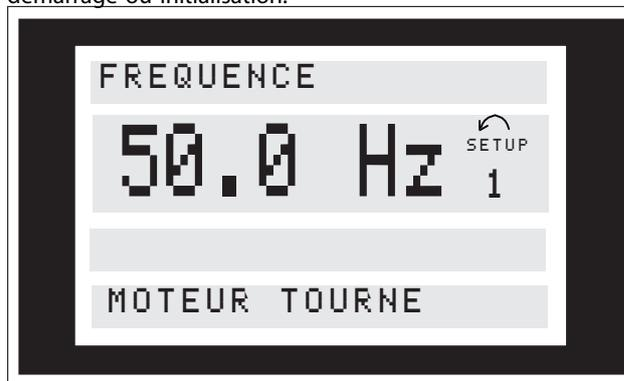
La ligne 2 indique la valeur d'une variable d'exploitation avec l'unité correspondante et la ligne 1 indique un texte qui explique la ligne 2, cf. tableau. Dans cet exemple, la fréquence a été sélectionnée comme variable par l'intermédiaire du paramètre 009. En fonctionnement normal, une autre variable peut être lue immédiatement par l'intermédiaire des touches [+/-].
