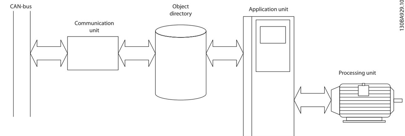
Abbildung 3.1 Funktionsprinzip der CANopen®-Knoten
