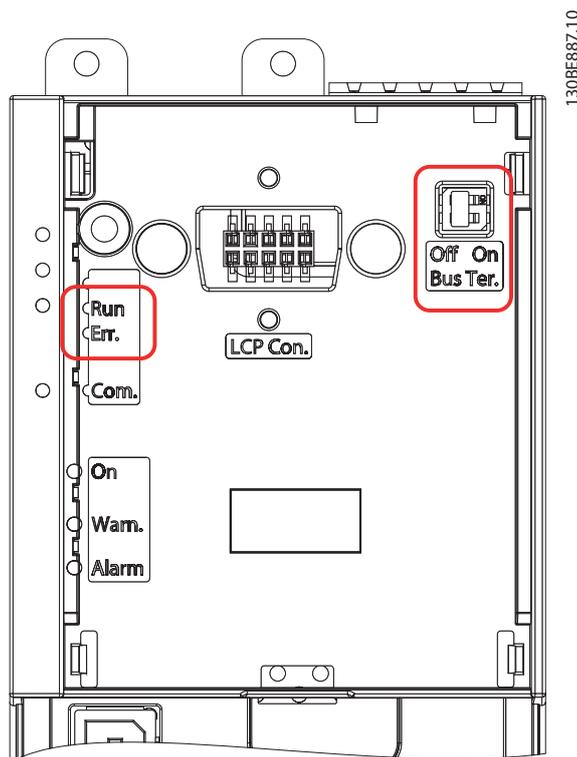
Abbildung 8.1 Kontrollleuchtenanzeige
