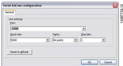
Der Bus muss im Konfigurationsfenster des Feldbusses hinzugefügt und konfiguriert werden. Wenn der Bus bereits dem Netzwerk hinzugefügt wurde, ist eine Neukonfiguration durch Rechtsklick auf den entsprechenden seriellen Bus des Softstarters möglich.
