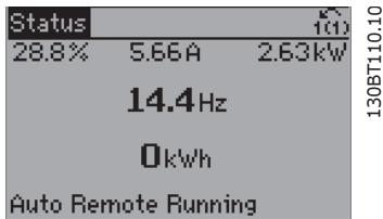
Ilustración 6.2: Paso 1: Encienda el convertidor de frecuencia (el LED amarillo se ilumina)
