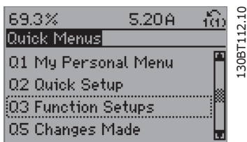
Ilustración 6.4: Paso 3: Use las teclas de navegación arriba/abajo para desplazarse por los Ajustes de función. Pulse [OK] (Aceptar)
