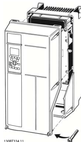
Illustration 2.14 Accès au câblage de commande pour les protections IP55/Nema 12 et IP66/Nema 4/4X intérieur
