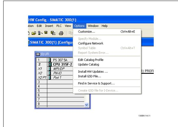
Wählen Sie mithilfe des Browsers für die GSD-Datei die Option Alle Dateien, damit die GSD-Datei sowie eine Bitmap-Datei für das Gerät in den Hardwarekatalog importiert werden.
