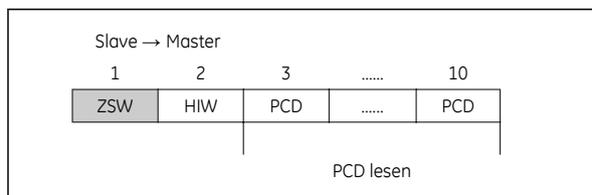
PCD 1 enthält ein 16-Bit-Zustandswort, wobei jedes Bit Informationen zu einem möglichen Zustand des Frequenzumrichters enthält.
