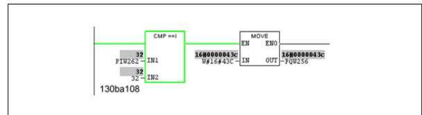
Dieses Netzwerk reversiert den Motor, wenn Digitaleingang 19 gleich „1“ (Ein) ist, weil Par. O-54 *Reversierung* auf Bus UND Klemme programmiert ist.
