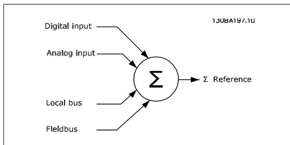
Der Sollwert oder Drehzahlsollwert (HSW, gesendet über Profibus) wird immer im Prozentformat als Ganzzahl in Hexadezimaldarstellung (0-4000 Hex) an den Frequenzumrichter übertragen.
