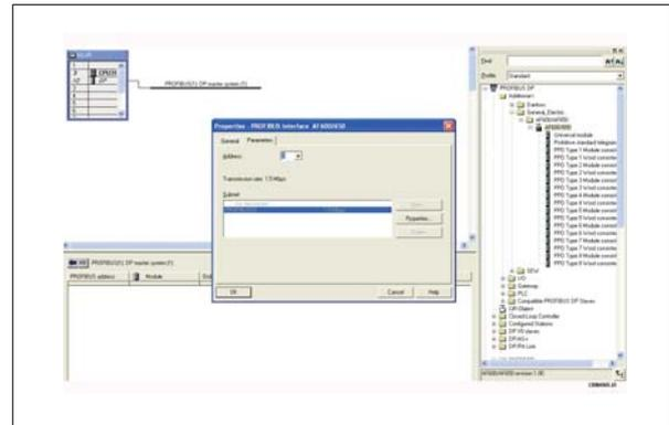
Anschließend werden die peripheren Ein- und Ausgangsdaten eingestellt. Im peripheren Bereich eingestellte Daten werden zyklisch über PPO-Typen übertragen. Im nachstehenden Beispiel wird ein PPO-Typ 6 W per Drag-and-Drop im ersten Steckplatz abgelegt.
