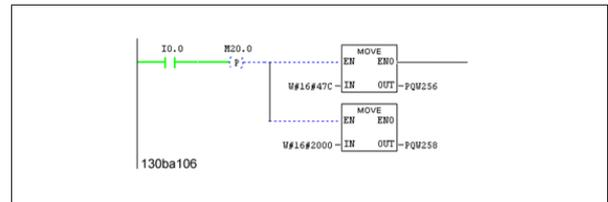
Dieses Netzwerk liest das Motordrehmoment vom Frequenzrichter. Es wird ein neuer Sollwert zum Frequenzrichter gesendet, weil das Motordrehmoment (86,0 %) höher als der verglichene Wert ist.
