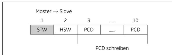
PCD 1 enthält ein 16-Bit-Steuerwort, in dem jedes Bit eine spezielle Funktion des Frequenzumrichters steuert, siehe Abschnitt *Steuerprofil*. PCD 2 enthält einen 16-Bit-Drehzahlsollwert im Prozentformat. Siehe auch Abschnitt *Sollwertverarbeitung*
