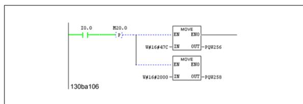
Ce réseau lit le couple moteur à partir du variateur de fréquence. Une nouvelle référence sera envoyée au variateur de fréquence parce que le couple moteur (86,0 %) est supérieur à la valeur comparée.
