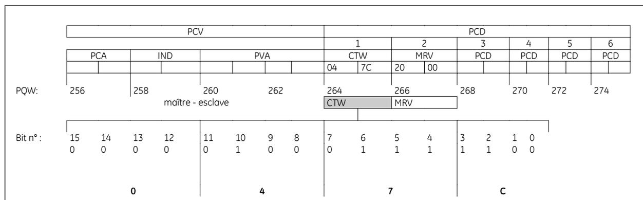
La table au-dessus indique les bits contenus à l'intérieur du mot de contrôle, et comment ils sont présentés comme des données de processus dans le PPO de type 3 de cet exemple.
