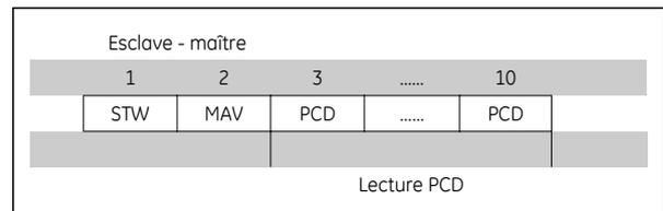
PCD 1 contient un mot d'état de 16 bits, où chaque bit contient des informations concernant un état possible du variateur de fréquence. PCD 2 contient par défaut la valeur de la vitesse actuelle du variateur de fréquence sous forme de pourcentage (voir également *Utilisation des références*). PCD 2 peut être configuré pour contenir d'autres signaux de process.
