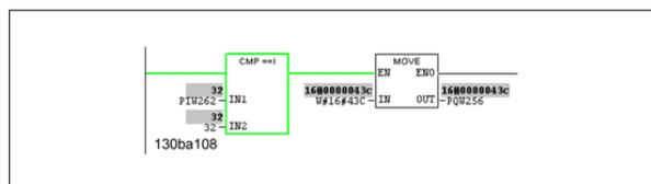
Ce réseau inverse le moteur lorsque l'entrée digitale 19 est active car le par. O-54 *Select.Invers.* est programmé sur Digital et bus.
