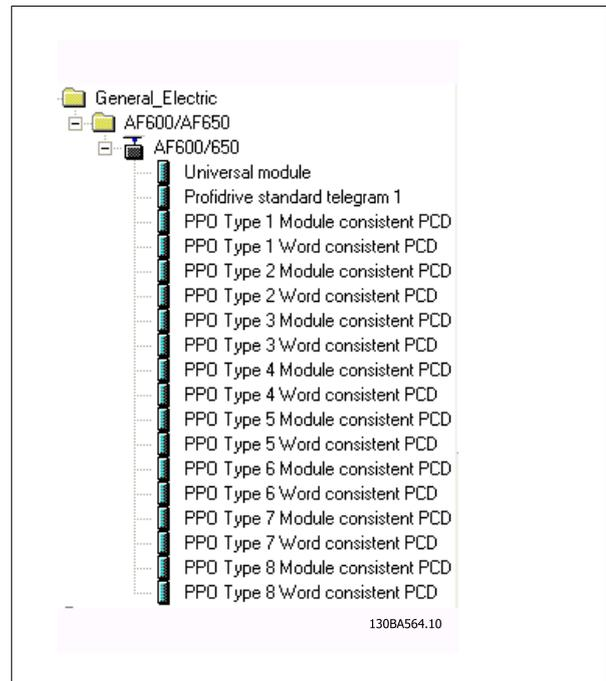
Ouvrir un projet, installer le matériel et ajouter un système de Maître PROFIBUS. Sélectionner la série AF-6 puis le faire glisser sur le PROFIBUS dans le diagramme Matériel.
