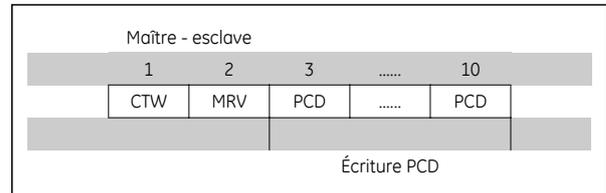
PCD 1 contient un mot de contrôle de 16 bits, où chaque bit contrôle une fonction spécifique du variateur de fréquence, voir le chapitre *Profil de contrôle*. PCD 2 contient un point de consigne de vitesse à 16 bits sous forme de pourcentage. Voir également *Utilisation des références*.
