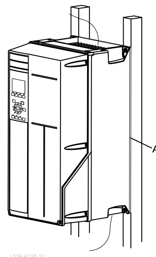
Bild 2.3 Korrekt montering med skenor
