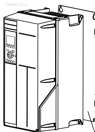
Ilustracja 2.2 Poprawny montaż na płycie tylnej
