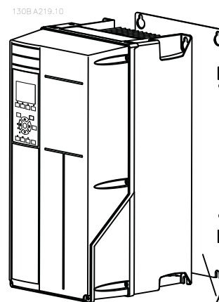
Рисунок 2.2 Правильная установка с использованием задней панели
