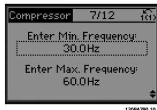
Abbildung 3.7 Einrichtung der min. und max. Frequenz
