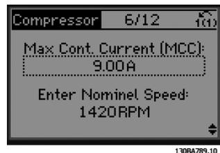
Abbildung 3.6 Strom- und Nenndrehzahleinrichtung
