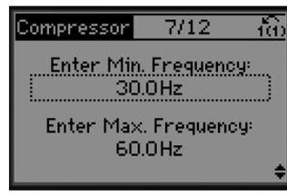
Illustration 3.7 Réglage des fréquences min. et max.
