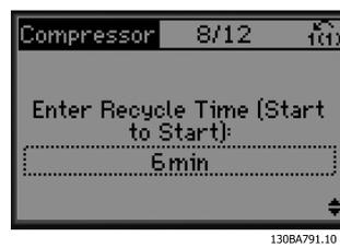
Ilustración 3.8 Tiempo mínimo entre dos arranques
