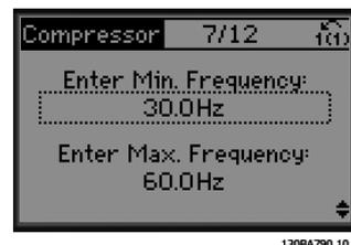
Disegno 3.7 Configurazione min. e max. della frequenza
