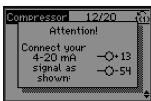
Bild 3.13 Info: 4-20 mA, återkoppling vald - anslut därefter
