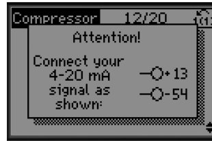
Ilustracija 3.13 Podatki: Izbrana povratna zveza 4–20 mA – ustrezno povežite
