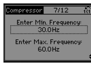
図 3.7 最低および最高周波数設定
