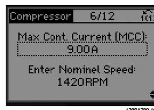
図 3.6 電流と公称速度設定
