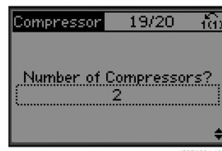
図 3.21 パック内のコンプレッサー数を設定します
