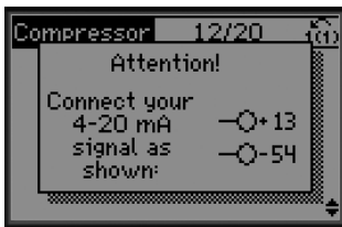
Çizim 3.13 Bilgi: 4-20 mA Geri Besleme Seçili - Uygun Şekilde Bağlayın
