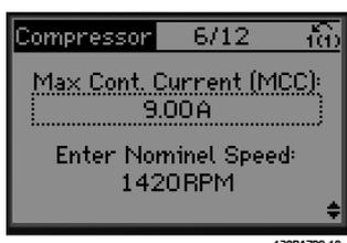
圖 3.6 電流和額定轉速設定
