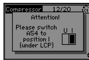
Ilustrația 3.14 Informații: Setarea corespunzătoare a comutatorului
