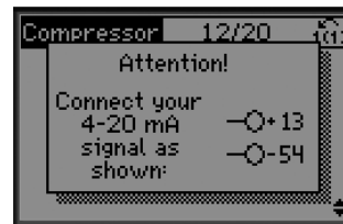
Obrázek 3.13 Info: Zvolená zpětná vazba 4–20 mA – zapojte odpovídajícím způsobem
