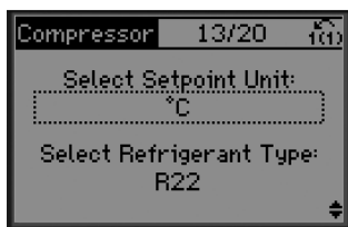
Ilustracja 3.15 Wybieranie jednostki i konwersji z ciśnienia
