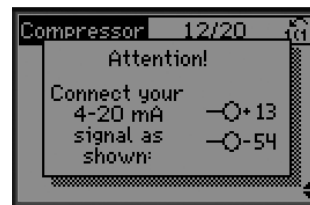
Ilustracja 3.13 Informacja: Wybrano sprzężenie zwrotne 4–20 mA — należy dokonać odpowiednich połączeń
