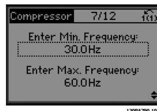
Ilustracja 3.7 Konfiguracja częstotliwości minimalnej i maksymalnej
