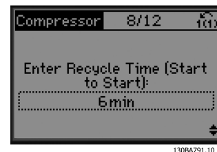
ภาพประกอบ 3.8 การตั้งค่าช่วงเวลาต่ำสุดระหว่างการสตาร์ทสองครั้ง
