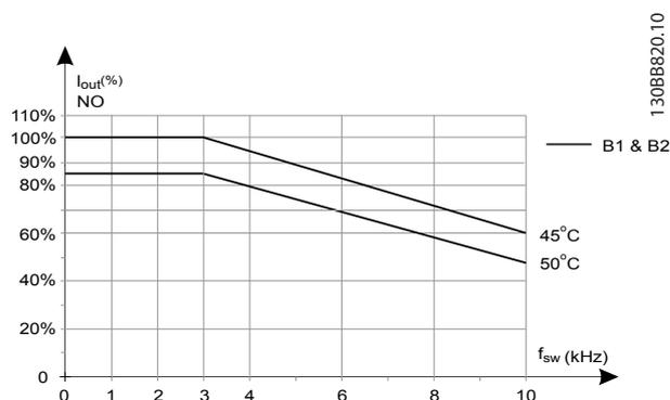
Ilustração 5.10 Derating da corrente de saída com frequência de chaveamento e temperatura ambiente para conversores de frequência de 600 V, gabinete metálico tamanhos B, 60 AVM, NO
