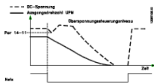
Abbildung 3.38 Geregelte Rampe ab, längerer Netzausfall
