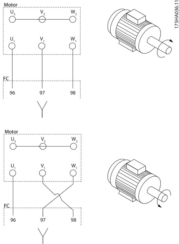
Abbildung 4.3 Motorreihungsprüfung
