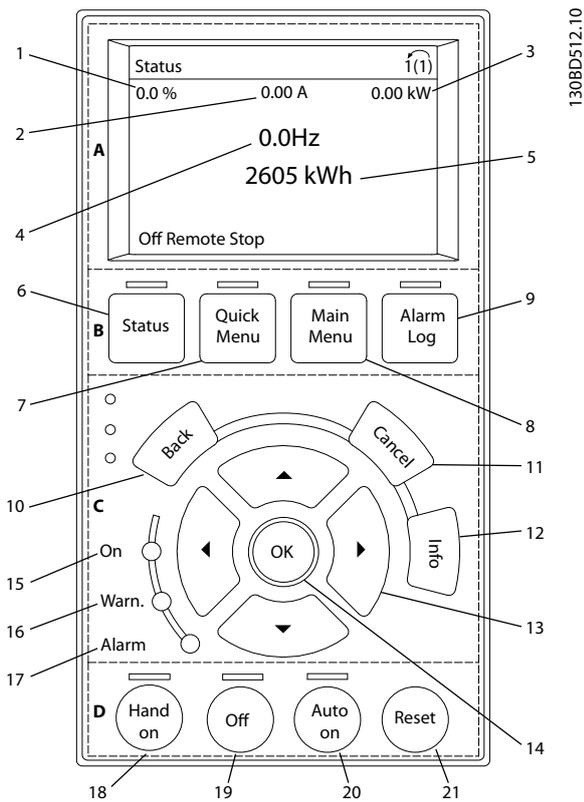
Abbildung 5.1 Bedieneinheit (LCP)
