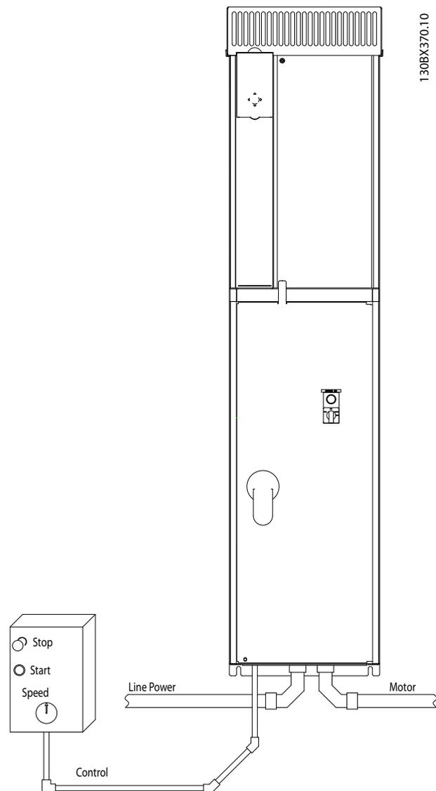
Abbildung 4.4 Beispiel für sachgemäße elektrische Installation über Kabelkanäle
