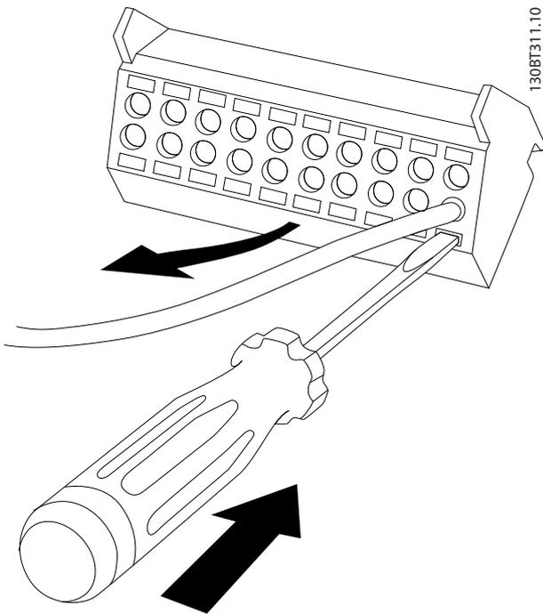
Abbildung 4.11 Entfernen des Schraubendrehers nach Einsetzen des Kabels
