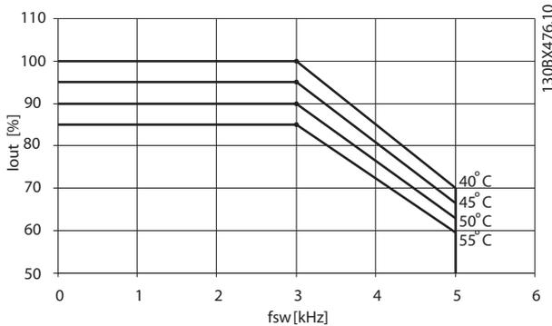
**Abbildung 8.2** Leistungsreduzierung Baugröße D, N160 bis N250 380-480 V (T5) Normale Überlast 110%, SFAWM
