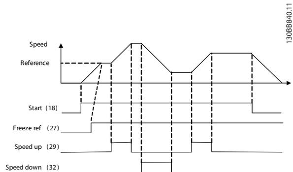
Abbildung 6.1 Drehzahl auf/Drehzahl ab
