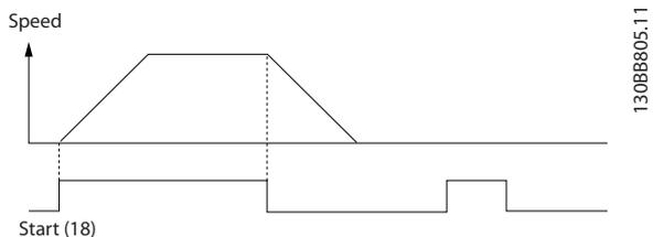
Abbildung 6.2 Start-/Stop-Befehl mit Safe Torque Off
