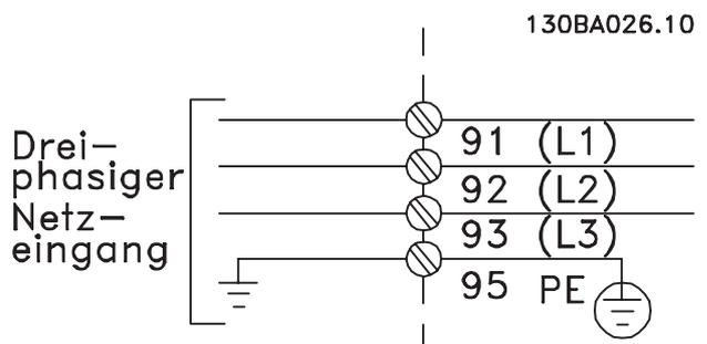
Abbildung 4.1 Leistungskabelanschlüsse
