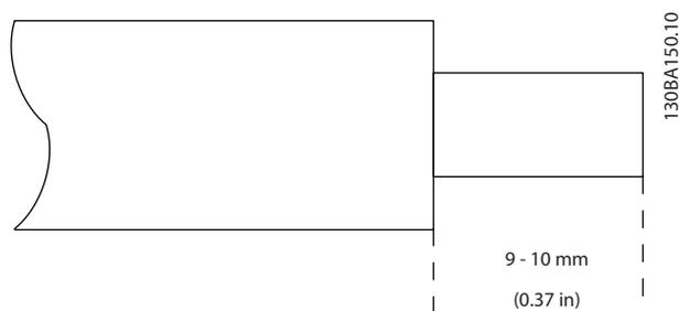
Abbildung 4.9 Abzuisolierende Länge
