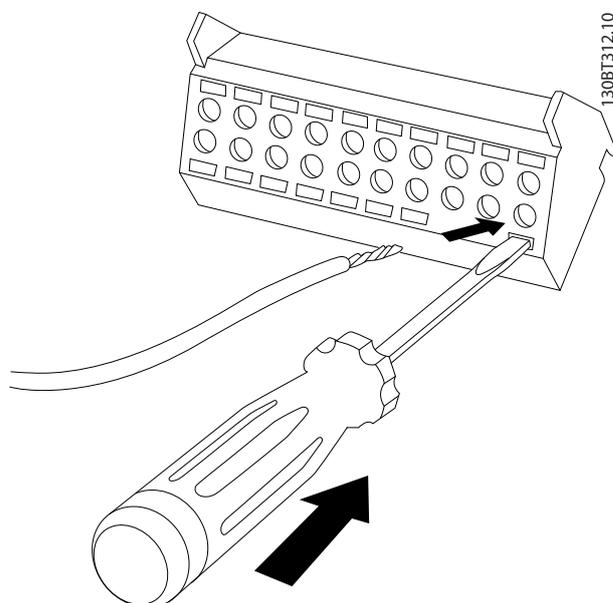
Abbildung 4.10 Einsetzen der Kabel in den Klemmenblock
