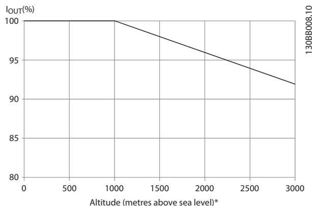
Abbildung 8.10 Höhenabhängige Leistungsreduzierung
