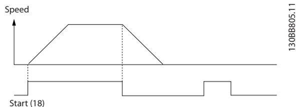
Illustration 6.2 Ordre de démarrage/arrêt avec Safe Torque Off
