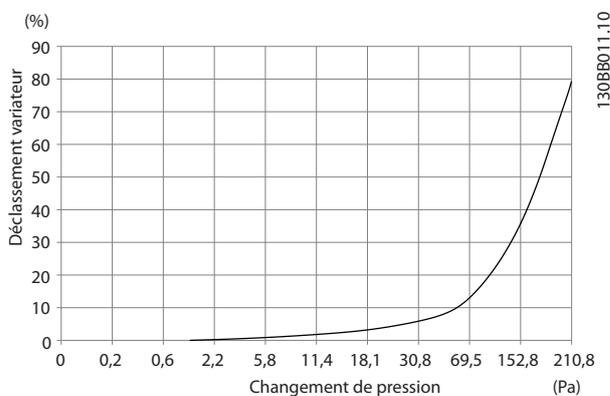
Illustration 3.3 Déclassement de la protection E en fonction du changement de pression Débit d'air du variateur de fréquence : 1445 m³/h (850 cfm)
