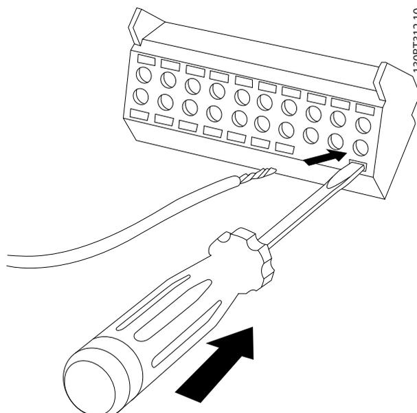
Illustration 4.10 Insertion du câble dans le bornier
