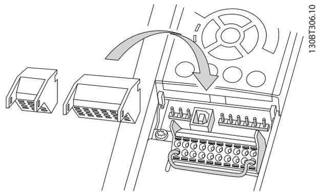
Illustration 4.12 Emplacement des bornes de commande
