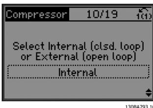
Abbildung 4.10 Auswahl von Betrieb mit oder ohne Rückführung
