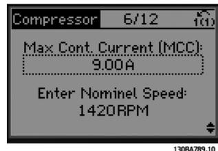
Abbildung 4.6 Strom- und Nenndrehzahleinrichtung
