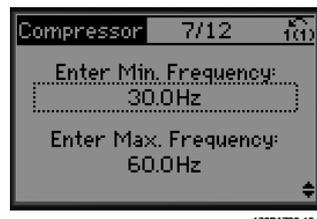
Abbildung 4.7 Einrichtung der min. und max. Frequenz
