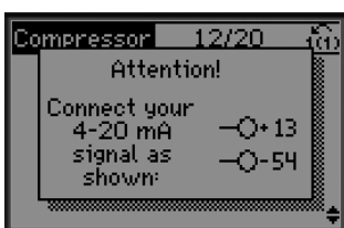
图 4.13 信息: 选择了 4-20 mA 反馈 - 进行相应连接
