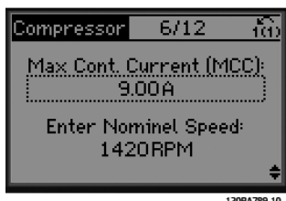
图 4.6 电流和额定速度设置
