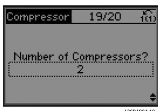
图 4.21 设置机组中的压缩机台数
