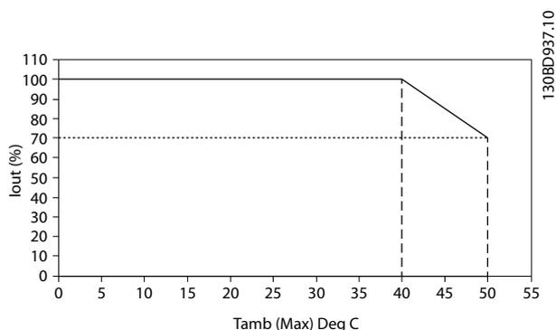
**Ilustración 8.11 Entrada/salida frente a temperatura ambiente máxima**
