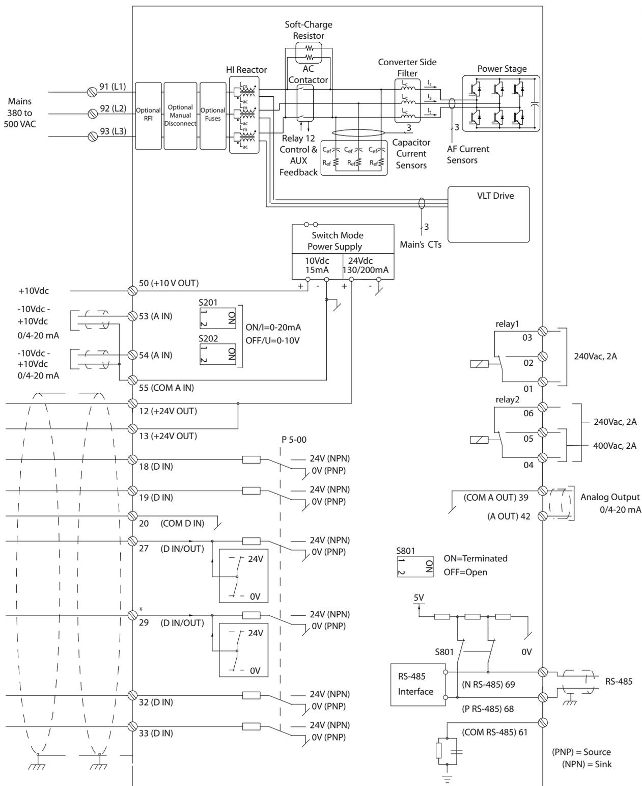
Ilustración 4.14 Diagrama de terminales del lado del filtro
