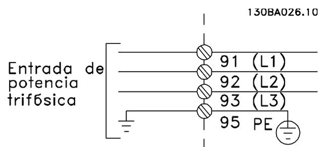
Ilustración 4.1 Conexiones de cable de alimentación
