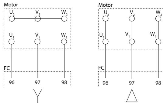
Ilustración 4.2 Configuraciones de terminales Y y en triángulo
