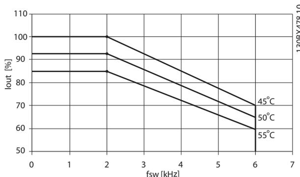
Ilustración 8.3 Reducción de potencia en alojamientos de tamaño E y F, P315 a P710, 380-480 V (T5) en modo de sobrecarga normal, 110 %, 60 AVM
