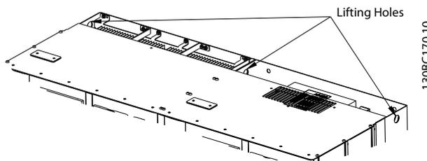
图 3.6 建议的起吊方法, 机箱规格 E9
