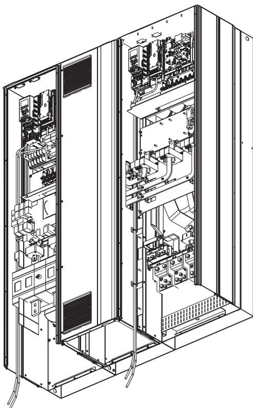
图 4.7 机箱规格 E9 的控制卡接线路径
