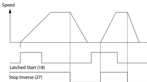
图 6.3 自锁启动/停止反逻辑
