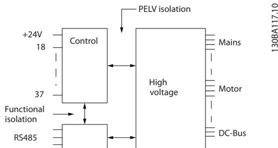
图 8.9 模拟输入的 PELV 绝缘
