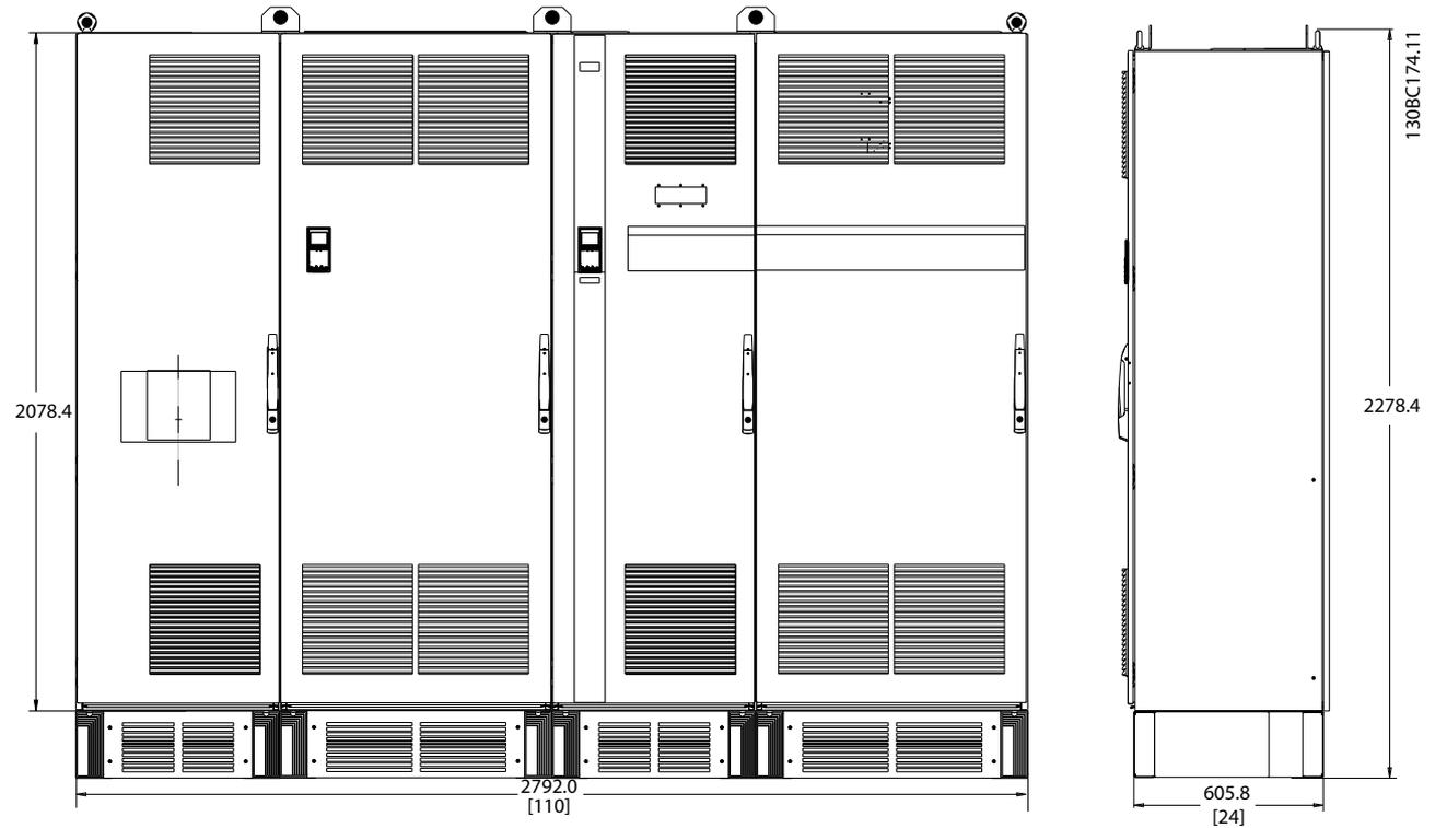
图 8.8 机箱规格 F18 (正视图和侧视图)
