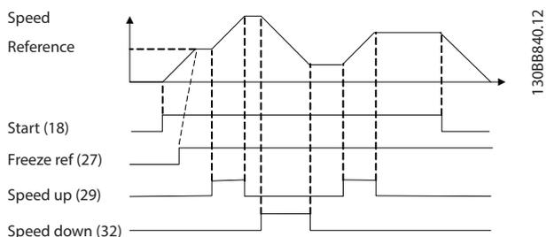
Ilustração 7.1 Aceleração/desaceleração
