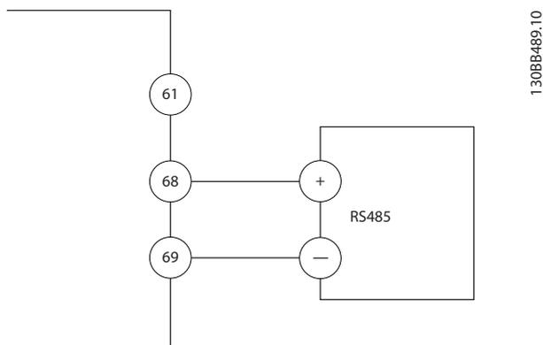
Ilustração 5.21 Diagrama da Fiação de Comunicação Serial
