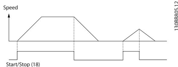
Ilustração 7.2 Comando de Partida/Parada com Safe Torque Off
