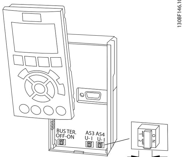
Ilustração 5.22 Localização dos Interruptores dos Terminais 53 e 54
