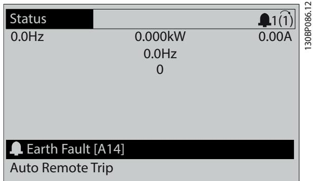
Рисунок 8.3 Пример аварийного сигнала
