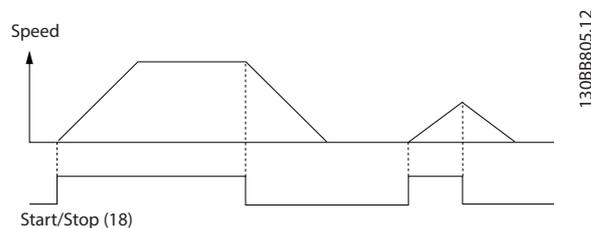
Рисунок 7.2 Команда пуска/останова с Safe Torque Off
