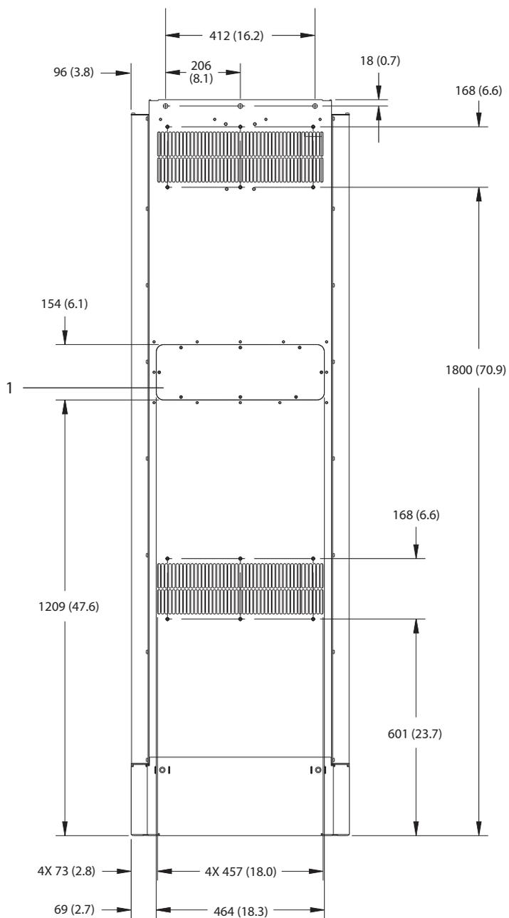
Рисунок 9.4 Вид сзади E1h
