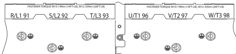
Рисунок 5.5 Клеммы заземления (показан корпус E1h). Детальный вид расположения клемм см. в глава 5.7 Размеры клемм.
