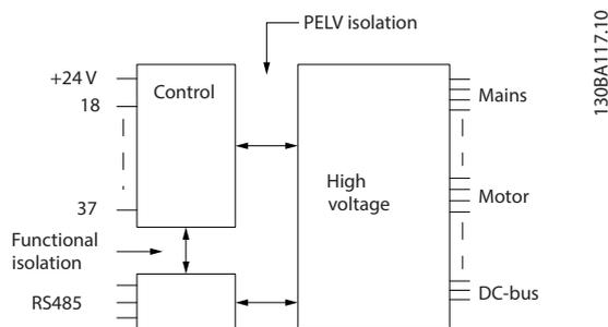
Рисунок 9.1 Изоляция PELV
