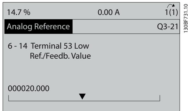
Рисунок 6.10 Параметр 6-14 Клемма 53, низкое зад./обр. связь
