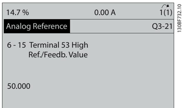
Рисунок 6.11 Параметр 6-15 Клемма 53, высокое зад./обр. связь
