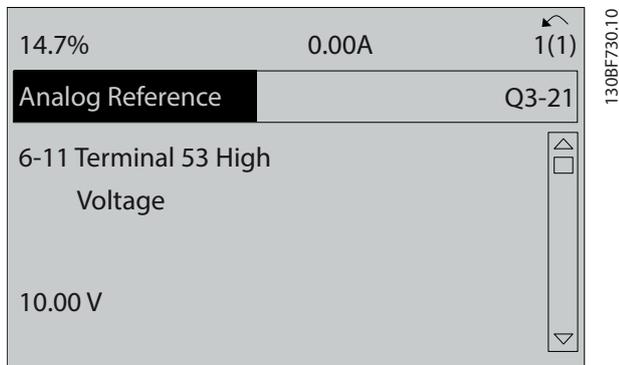
Рисунок 6.9 Параметр 6-11 Клемма 53, высокое напряжение
