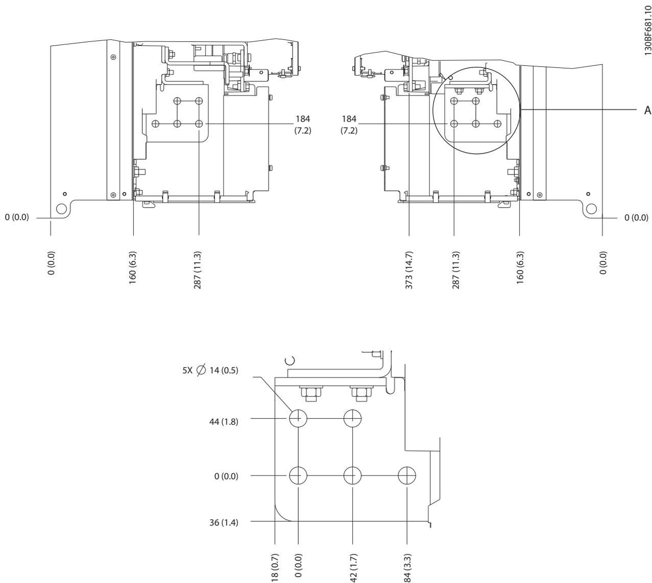
Рисунок 5.14 Размеры клемм подключения сети питания, двигателя и заземления в корпусе E4h (вид сбоку)
