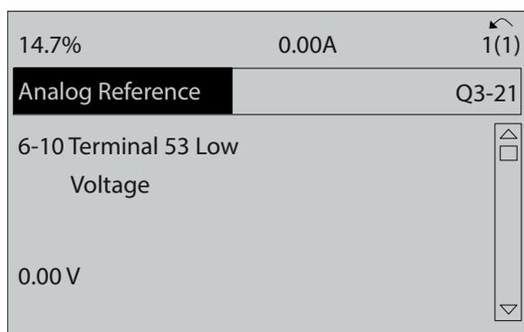
Рисунок 6.8 Параметр 6-10 Клемма 53, низкое напряжение
