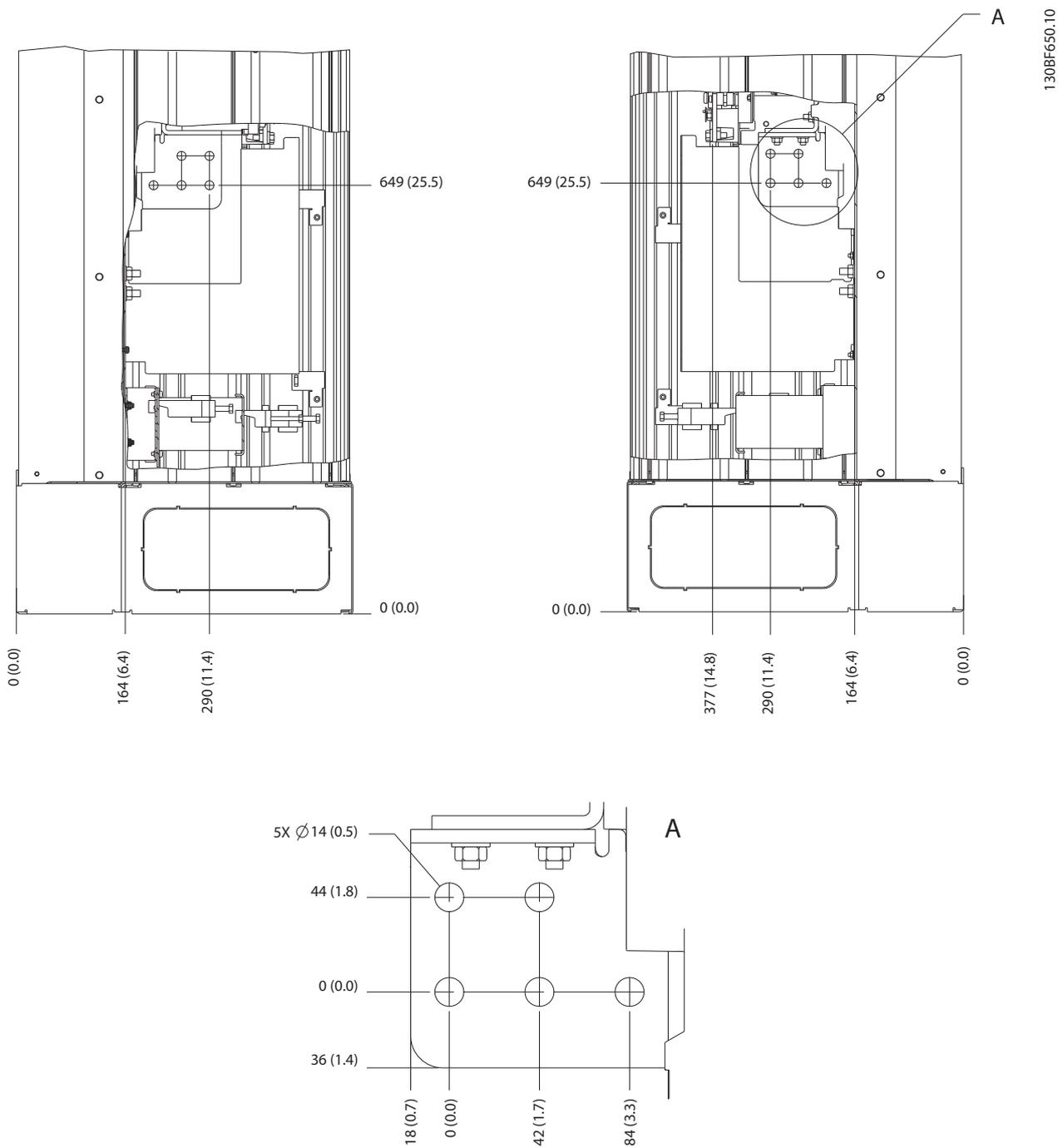
Рисунок 5.7 Размеры клемм корпуса E1h (вид сбоку)
