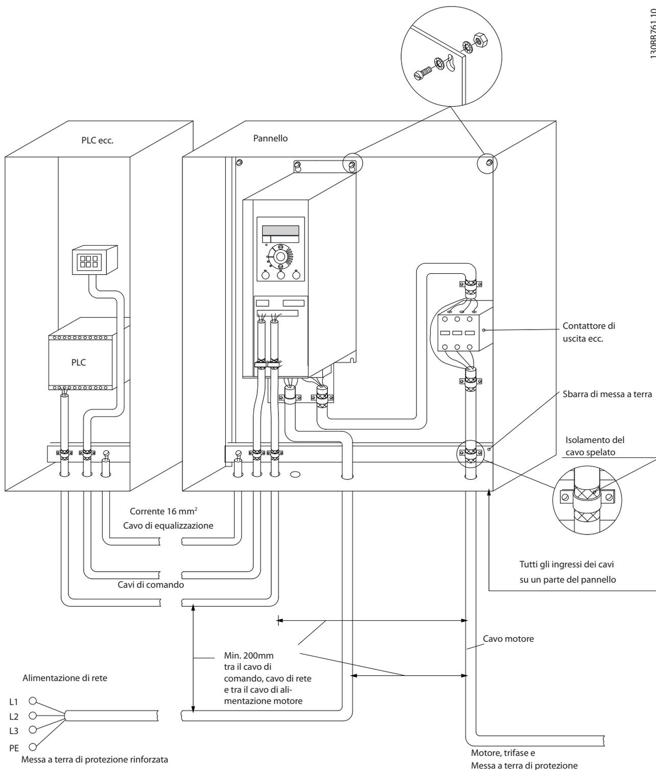
Disegno 3.21 Installazione elettrica conforme ai requisiti EMC
