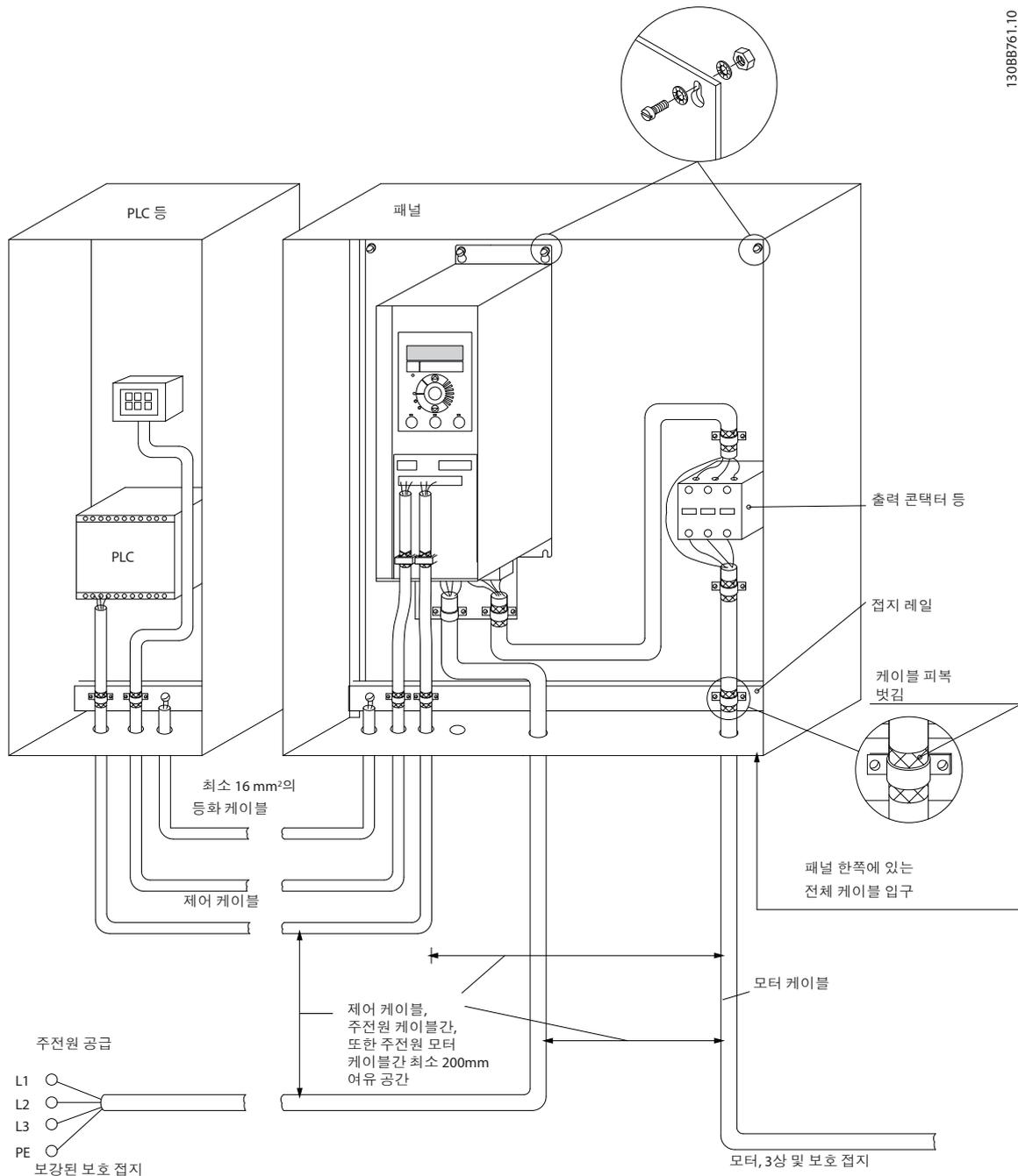
그림 3.21 EMC 규정에 따른 전기적인 설치
