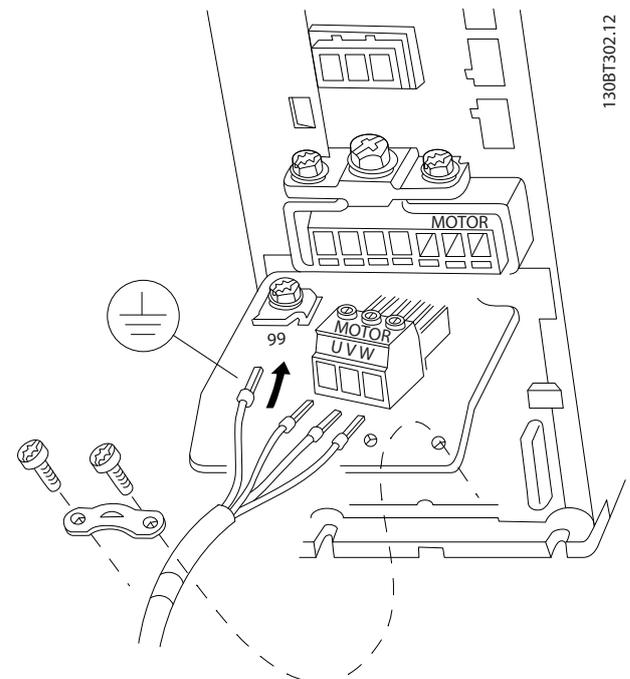
图 3.7 将变频器连接到电机, H9 机箱
