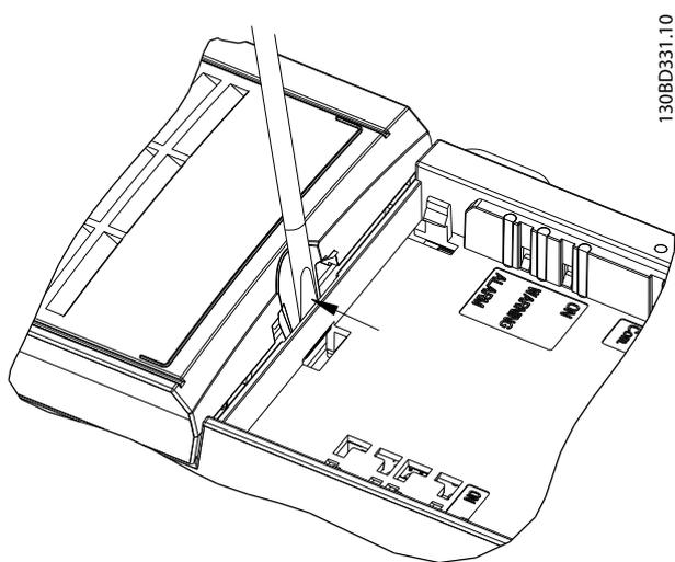
图 3.22 拆下端子盖
