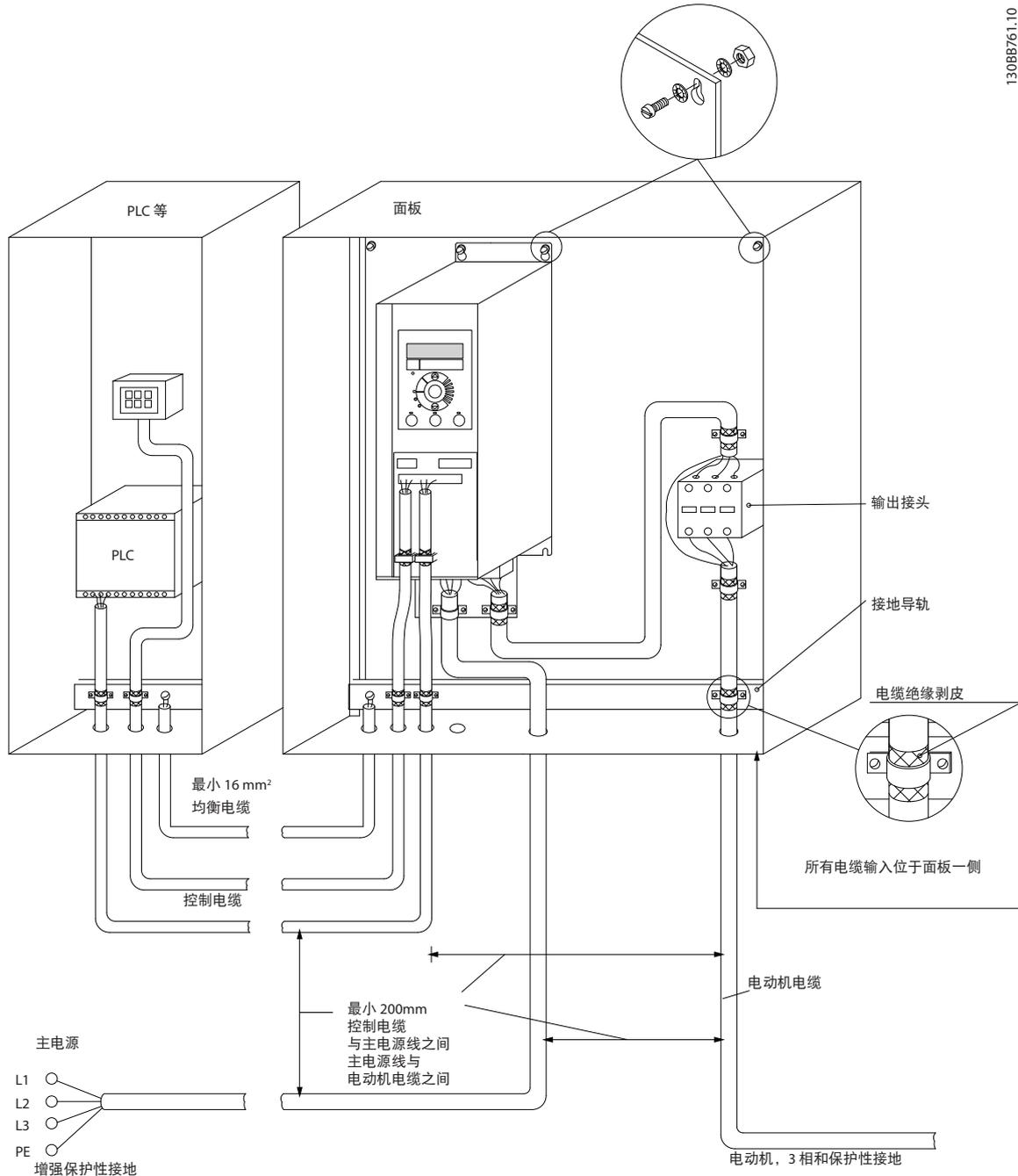
图 3.21 符合 EMC 规范的电气安装
