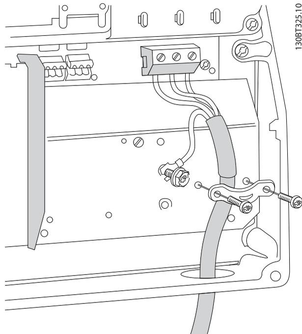
Illustration 3.18 Raccordement au moteur pour protection I6
