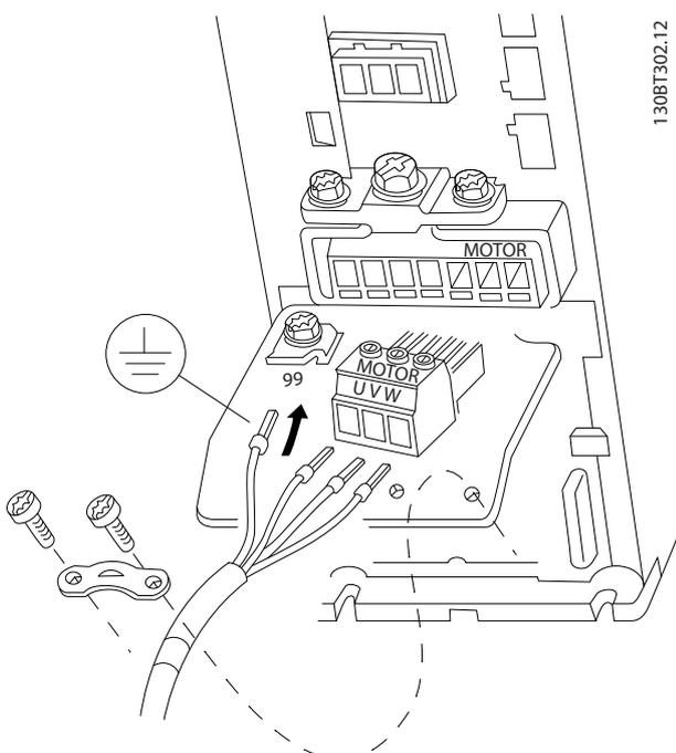
**Illustration 3.7 Raccordement du variateur de fréquence au moteur, protection de taille H9**
