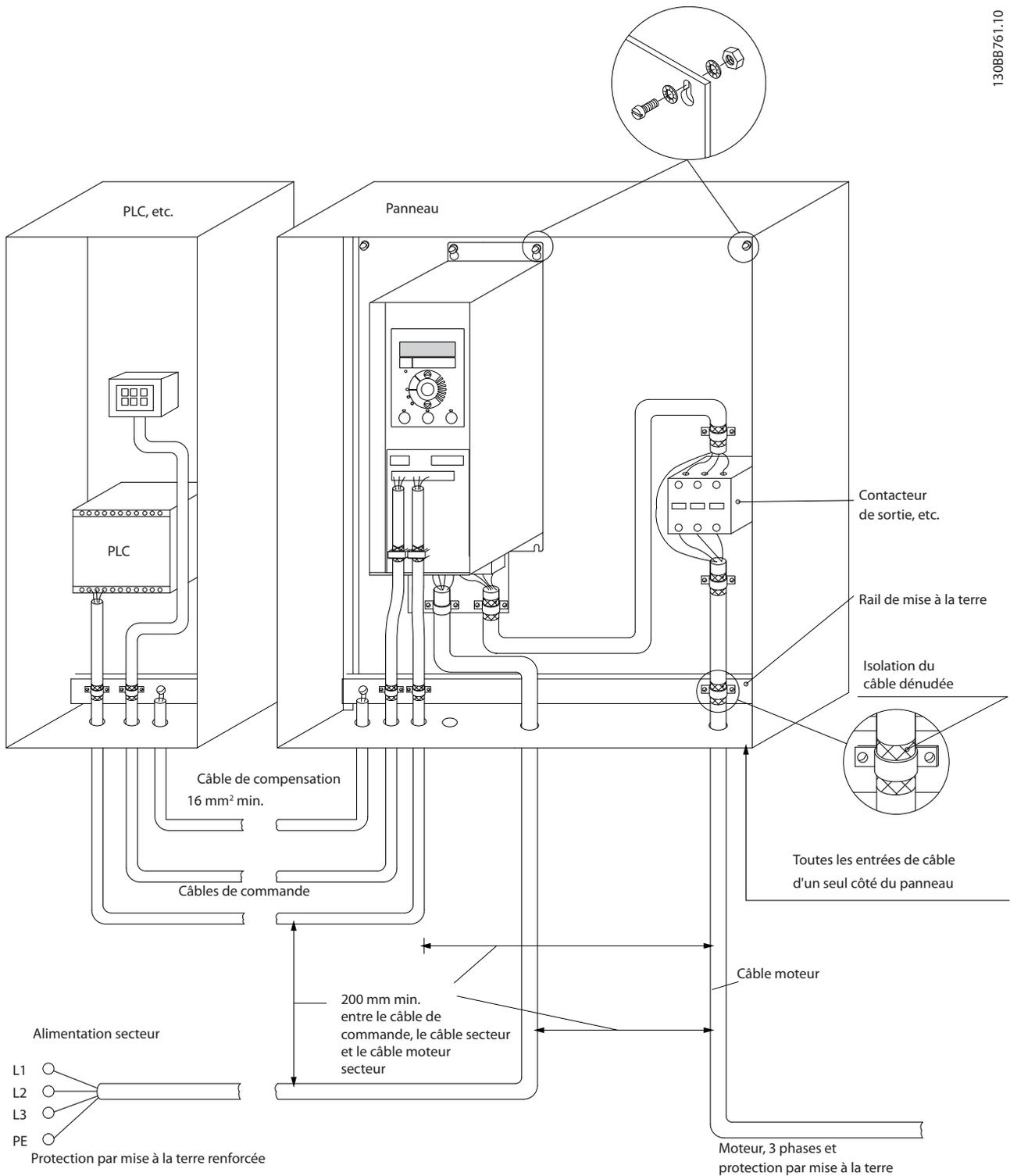
Illustration 3.21 Installation électrique conforme aux normes CEM
