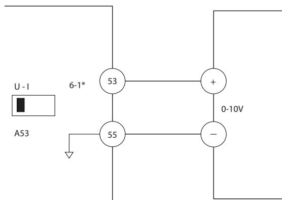
图 5.10 由外部设备提供 0-10 V 控制信号的接线示例
