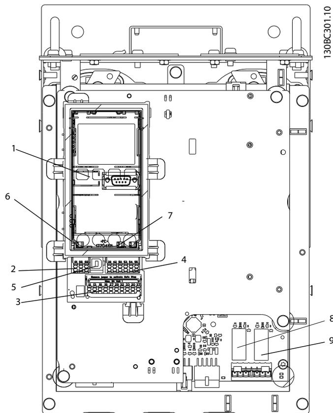
图 1.2 特写图：LCP 和控制功能
