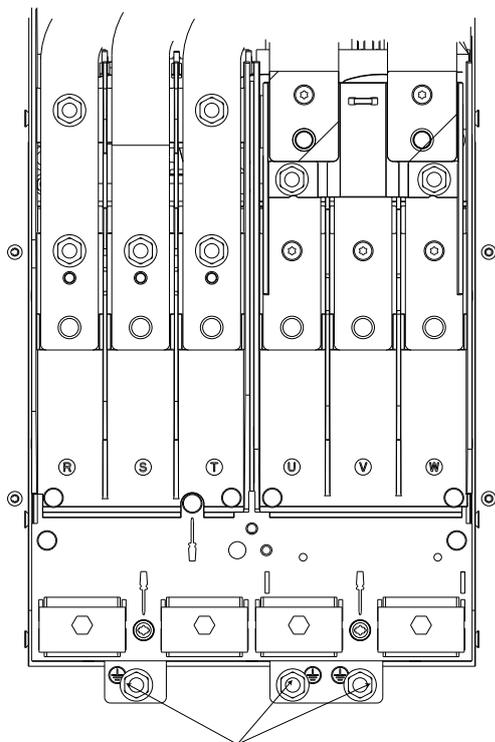
图 2.5 IP20（机架式）机箱的接地点
