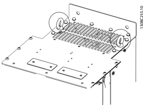
图 2.1 请将吊索系在指定位置
