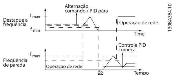
Ilustração 5.11 Alternância da bomba de comando
