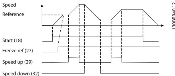
Ilustração 12.3 Aceleração/desaceleração
