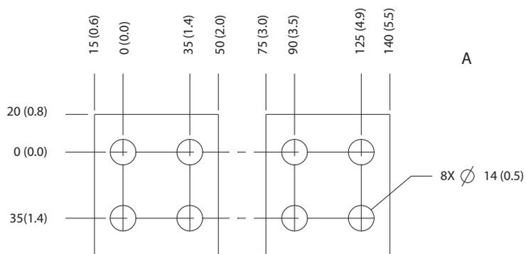
Ilustração 8.88 Dimensões de terminal de regeneração/divisão da carga do E3h
