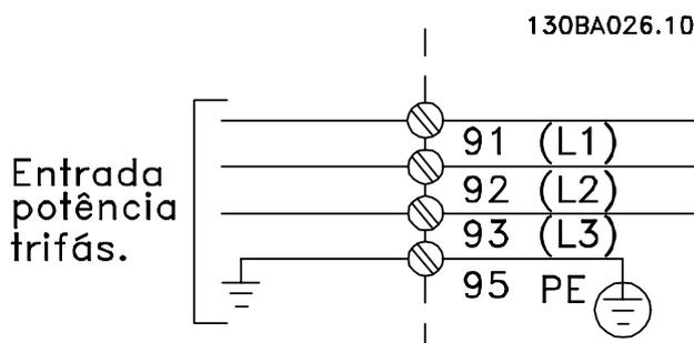
Ilustração 10.2 Conexões do cabo de energia
