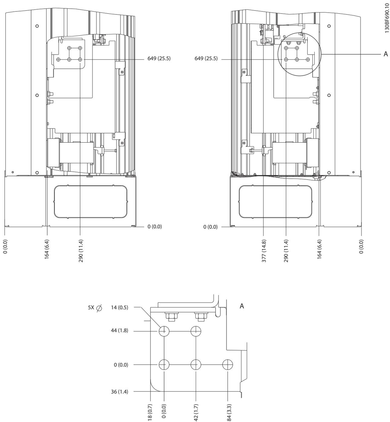
Ilustração 8.81 Dimensões do terminal E2h (vista lateral)
