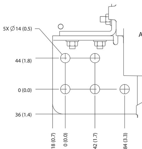
Ilustração 8.87 Dimensões de rede elétrica motor e ponto de aterramento do E3h (vista lateral)
