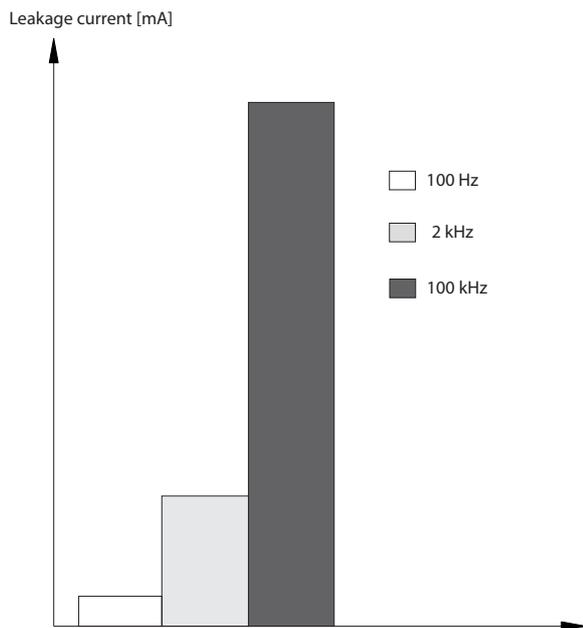
Ilustração 10.15 Influência da frequência de desativação do RCD na corrente de fuga
