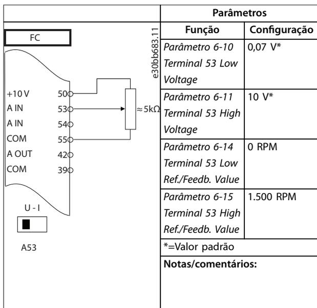
Tabela 12.9 Configuração de fiação para referência de velocidade (usando um potenciômetro manual)
