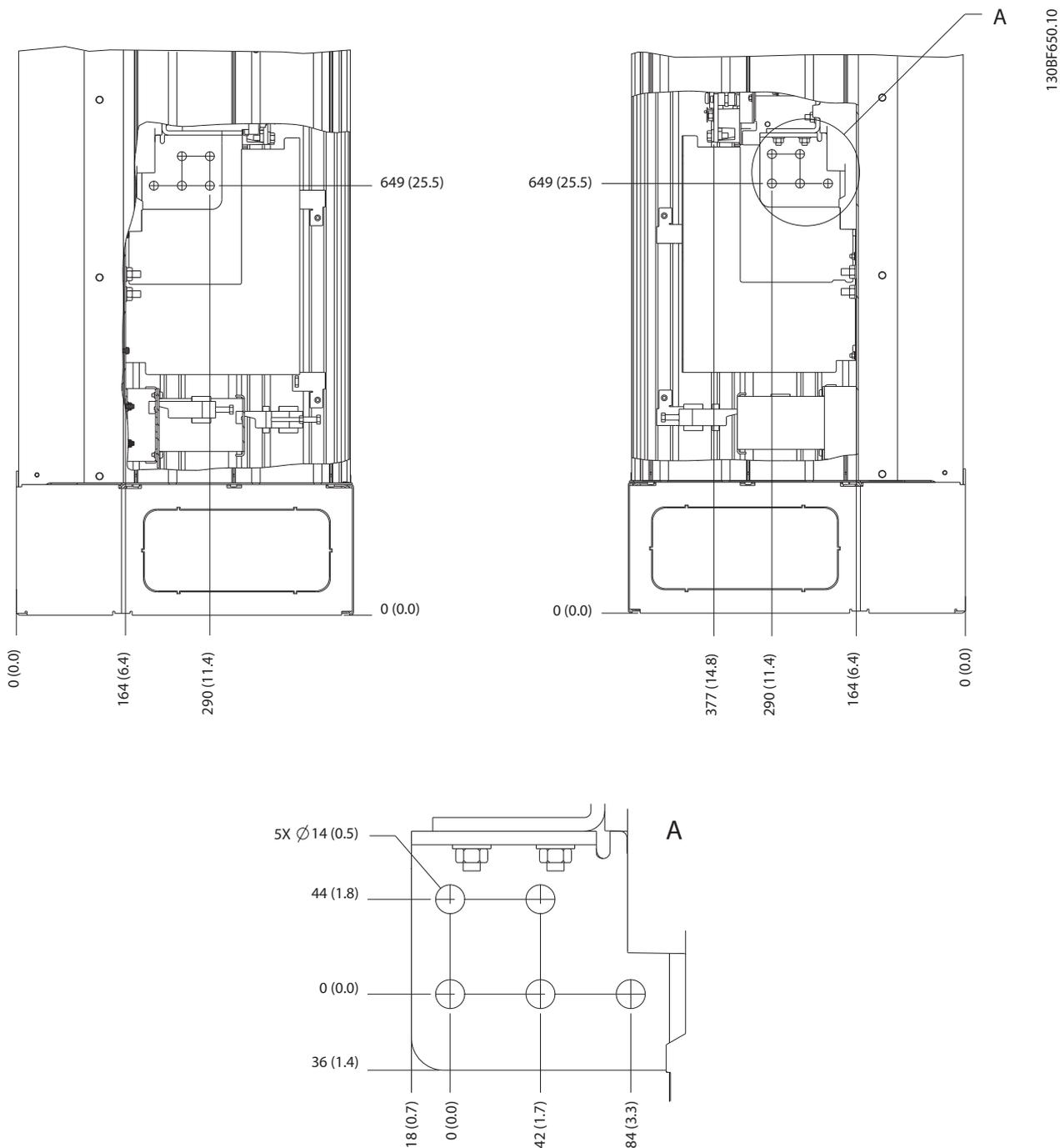
Ilustração 8.75 Dimensões do terminal E1h (visão lateral)
