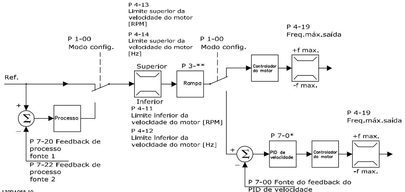
Ilustração 11.8 Estrutura de controle nas configurações de malha aberta e malha fechada do VVC<sup>+</sup>
