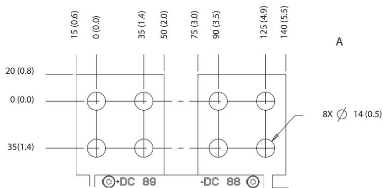
Ilustração 8.95 Dimensões de terminal de regeneração/divisão da carga do E4h
