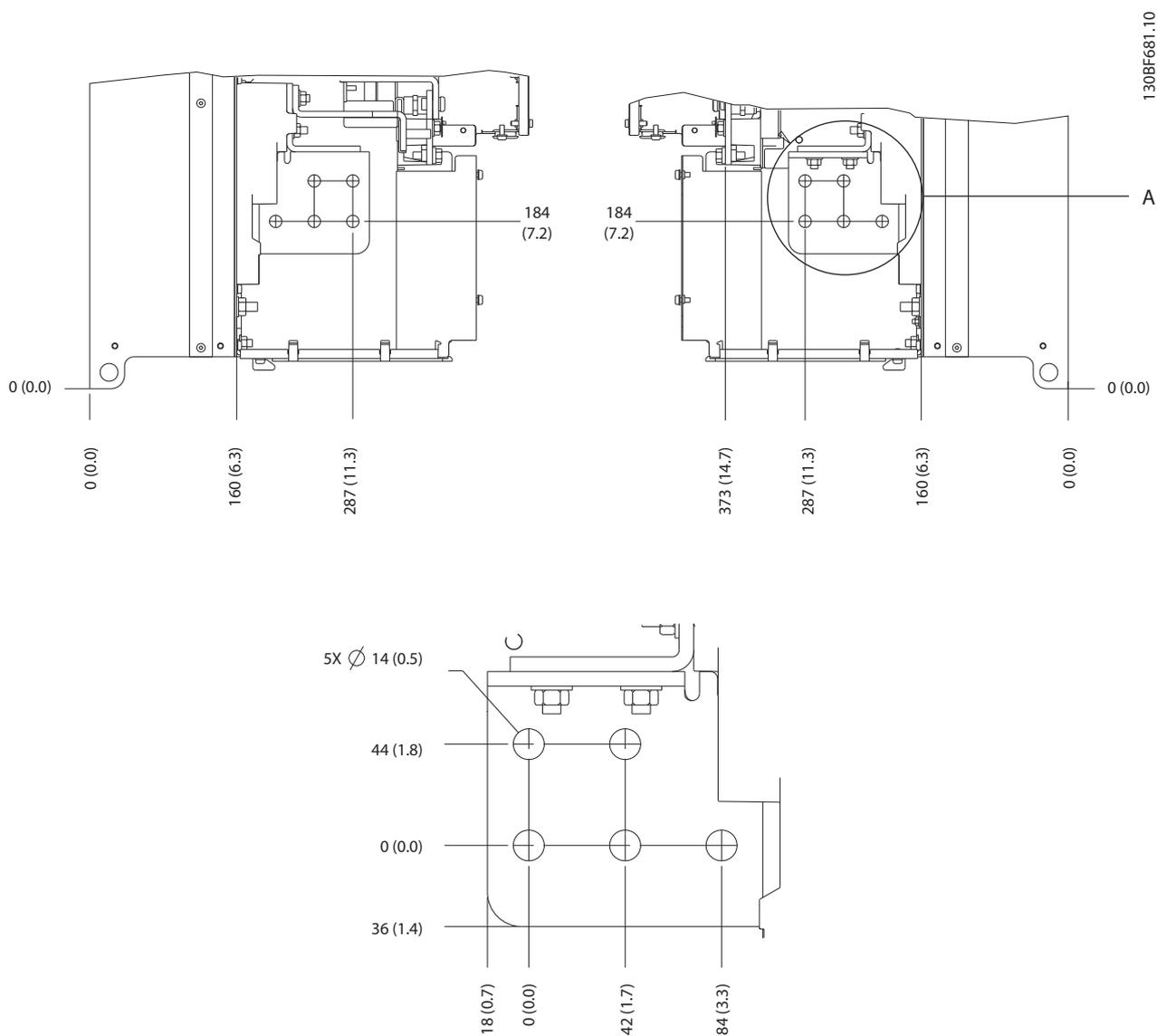
Ilustração 8.94 Dimensões de rede elétrica, motor e terminal do ponto de aterramento E4h (visão lateral)
