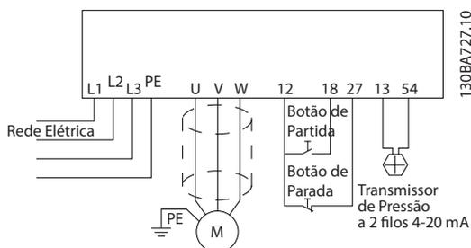
Ilustração 12.4 Fiação para aplicação de bomba submersível
