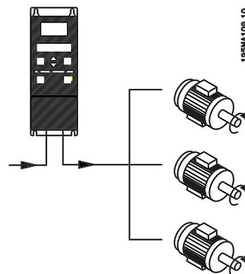
El convertidor de frecuencia puede controlar varios motores conectados en paralelo. Si hace falta que los motores tengan diferentes valores de rpm, utilice motores con diferentes valores nominales de rpm. El valor de rpm del motor cambia simultáneamente, lo que significa que la relación entre los valores nominales de rpm se mantiene en todo el rango. El consumo de energía total de los motores no debe superar la corriente de salida nominal máxima  $I_{NV}$  para el convertidor de frecuencia.
