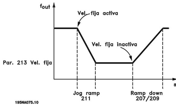
El tiempo de rampa de velocidad fija empieza si se da una señal de velocidad fija mediante el panel de control LCP, una de las entradas digitales o el puerto de comunicación serie.
