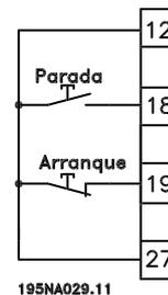
*Arranque de pulsos*, si se aplica un pulso durante 14 ms como mínimo, el convertidor de frecuencia arranca el motor, siempre que no se haya dado un comando de parada. El motor se puede parar momentáneamente si se activa *Parada inversa*.
