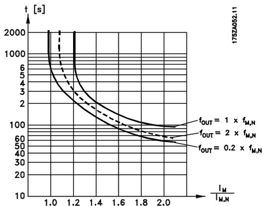
Las funciones ETR 1-4 no empiezan a calcular la carga hasta que se pasa al Ajuste en que se han seleccionado. Esto significa que se puede utilizar una función ETR incluso cuando se cambie entre dos o más motores.
