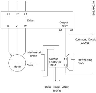
圖 2.21 將機械煞車連接致變頻器
