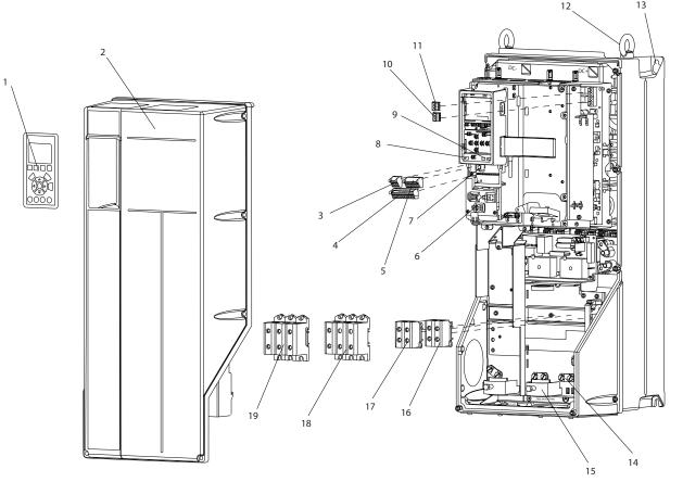
圖 1.2 大小 B 與 C 分解圖, IP55/66
