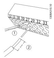
圖 2.13 連接控制線路
