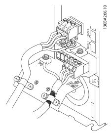
圖 2.7 使用具遮罩的電纜線接地
