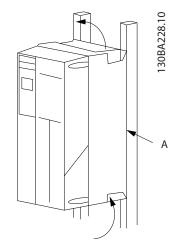
圖 2.3 使用欄杆的正確安裝
