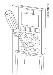
圖 2.9 A2、A3、B3、B4、C3 與 C4 外殼控制線路接入
