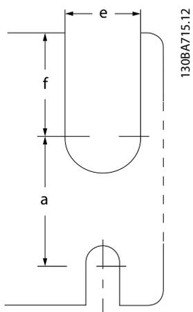
圖 8.3 頂部與底部安裝孔 (B4、G3 與 C4)
