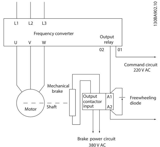
圖 4.6 將機械煞車連接致變頻器
