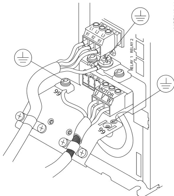
圖 4.5 馬達、主電源與接地線路的範例
