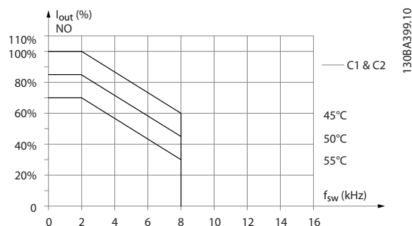
Disegno 6.25 Declassamento di I_{out} per diverse T_{AMB, MAX} per contenitori di tipo C1 e C2, usando SFAVM in modalità di sovraccarico normale (110% di sovraccoppia)
