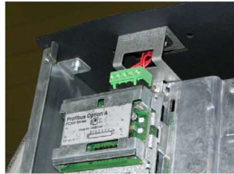
Ábra 3.53: A terepi busz csatlakoztatása felülről
