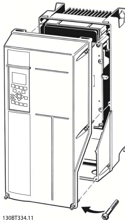
Illustration 2.9 Accès au câblage de commande pour les protections IP55/Nema 12 et IP66/Nema 4/4X intérieur
