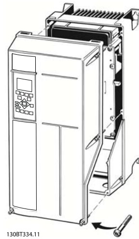
图 2.9 IP55 / Nema 12 和 IP66 / Nema 4/4X (室内) 的控制卡线路检视
