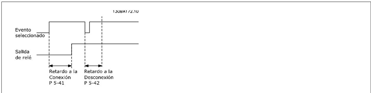
Si la condición de Evento seleccionada cambia antes de que expire el temporizador de retardo de conexión o desconexión, la salida de relé no se verá afectada.
